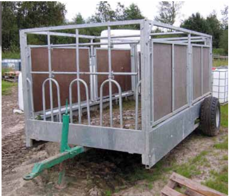
Kuva 5. Traktorilla hinattavaa eläinten kuljetusvaunua käyttämällä vasikoiden ja hiehojen siirto rakennusten välillä on sujuvampaa ja turvallisempaa kuin vapaasti liikkuvien eläinten ohjaaminen.
