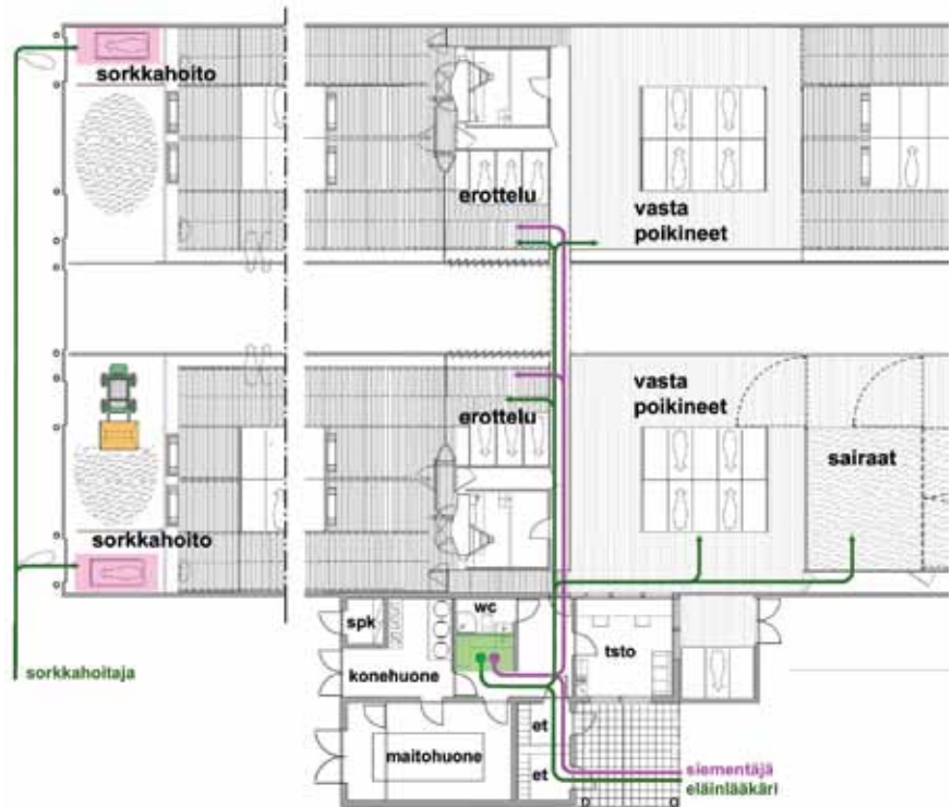
Kuva 17. Siementäjät vierailevat pihatossa lähes päivittäin, jolloin heidän tuloreittinsä, työpisteensä ja kulkureitti toimenpidelehmien luokse on tehtävä mutkattomaksi, turvallisiksi ja hygieeniseksi. Sama koskee eläinlääkäreiden työskentelyolosuhteita. Sorkkahoitajan työpiste perustetaan mahdollisimman kauas lypsyasemasta/-robotista pihattohallin päätyyn tai sinne, mistä lehmät luontaisesti kulkevat laiturille.
