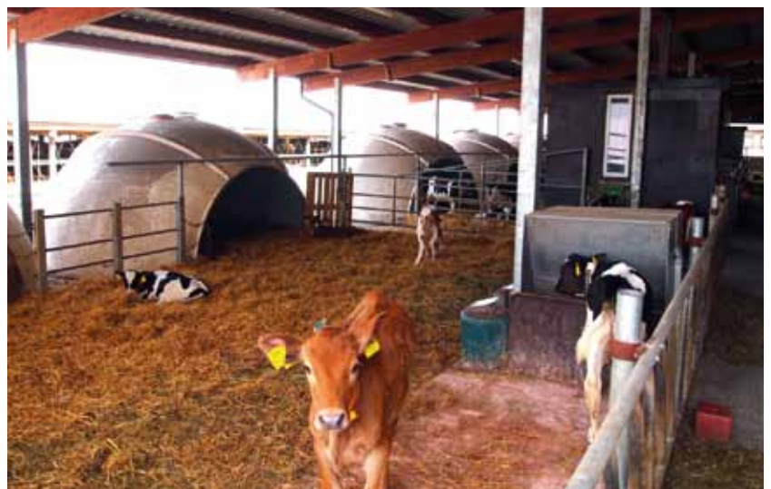
Kuva 11. Iglukasvatuksen vähimmäisvaatimuksena on, että iglujen sijoitusalue on katettu ja sen pohjarakenne on kiinteä, jotta lannanpoisto ja alueen yleinen puhtaanapito toimivat sujuvasti. Suojakatos voidaan toteuttaa pilari-palkki-rakenteena itsekantavalla profiilipellillä. Katoksesta voidaan tehdä varusteltu kiinteä kasvatusympäristö, jossa on tilat yksilö- ja ryhmäigluille, ruokintapöytä ja juottoautomaatti. Vasikoiden ryhmäytymisessä on otettava huomioon niiden nenäkosketusmahdollisuus jo yksilökarsinavaiheesta alkaen.
