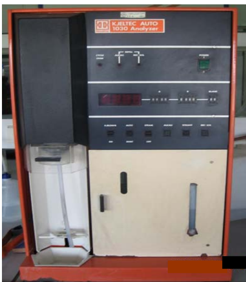
سنجش پروتئین به روش کج‌دال دستگاه کج‌دال اتوآنالایزر
