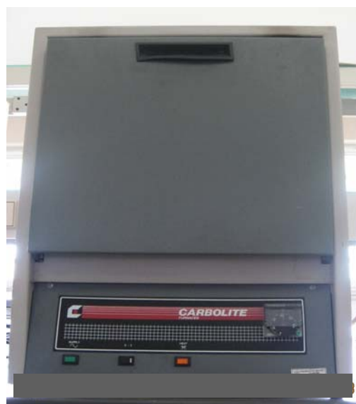
سنجش رطوبت: آون در دمای ۱۰۵ درجه به مدت ۲۴ ساعت
