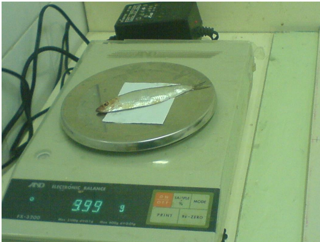
شکل ۲-۴ توزین ماهیان به کمک ترازوی دیجیتالی با دقت ۰/۰۱ گرم.
