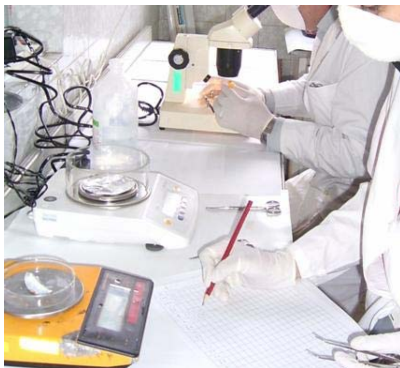
شکل ۲-۶. توزین و تعیین طول ماهی ها و ثبت اطلاعات در فرم های مخصوص
