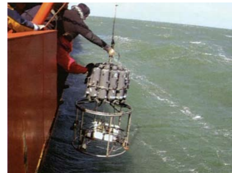
Maniobra con sonda CTD, utilizada para medir conductividad, temperatura y profundidad del agua.
