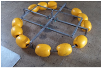
Figura 1. Estructura metálica con flotadores.
