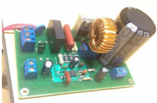
Figura 24. Tarjeta electrónica de la etapa AC-DC (Convertidor Boost PFC).
