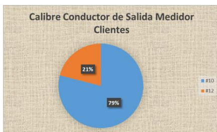
Figura 3.4. Calibre Conductor salida del medidor
