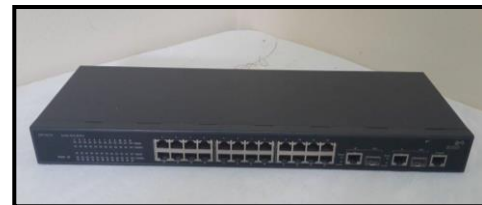
Figura 13. Switch para conexión MSC 1 Y MSCS 2
