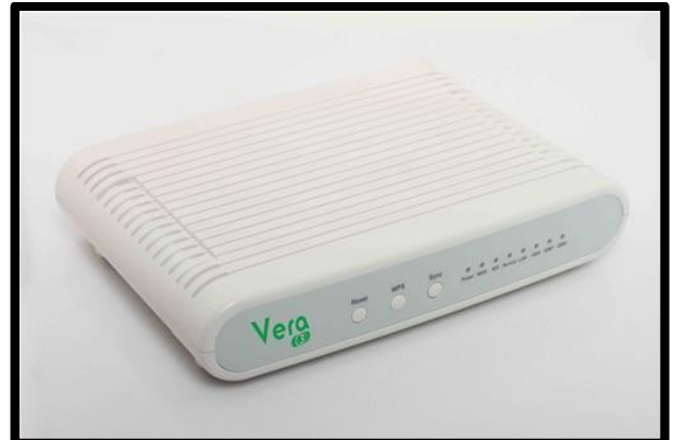
Figura 12. Dispositivo controlador del sistema domótico VERA3.
