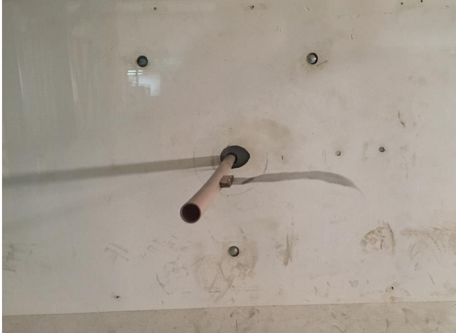
Ilustración 11 Montaje final túnel de viento – Generador de vórtices con placa, Diámetro 1 pulgada Fuente: Autor
