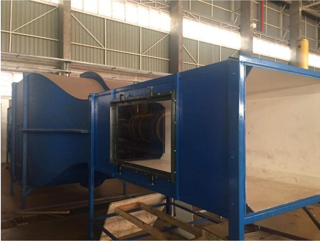
Ilustración 4 Túnel de viento Fuente: Autor
