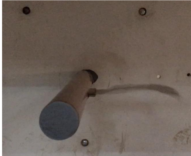
Ilustración 15 Estructura cilíndrica instalada en túnel de viento. Fuente: Autor.
