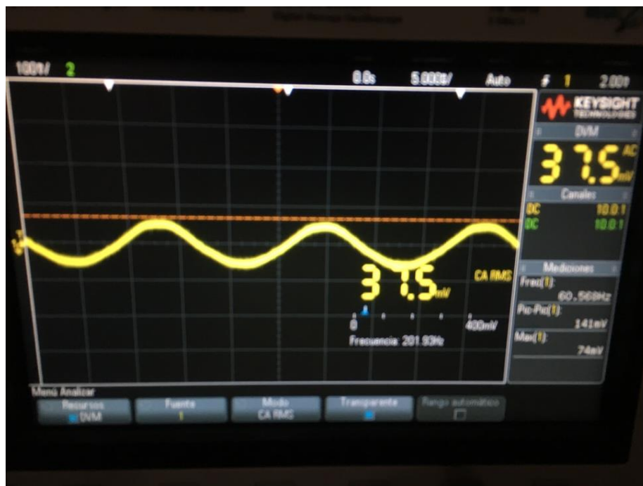
Ilustración 21 voltaje generado por el piezoeléctrico en milivoltios
