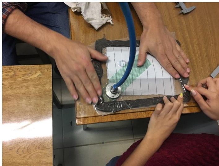
Ilustración 9 Pegado del material piezoeléctrico a la placa de aluminio al vacío. Fuente: Autor
