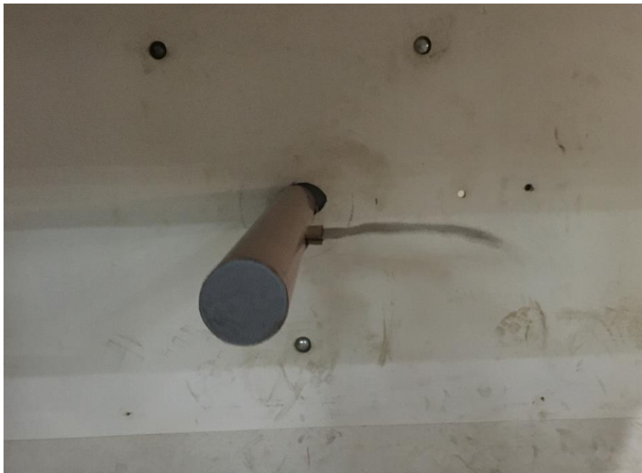
Ilustración 12 Montaje final túnel de viento – Generador de vórtices con placa, Diámetro 2 pulgadas Fuente: Autor
