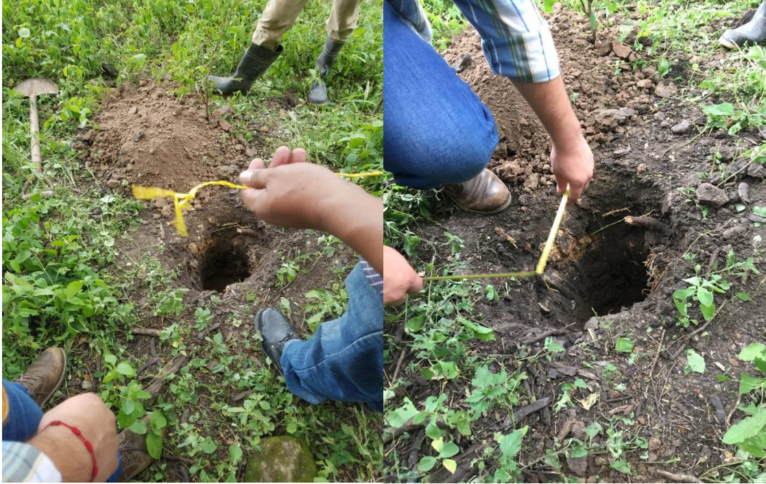
Prueba de infiltración
