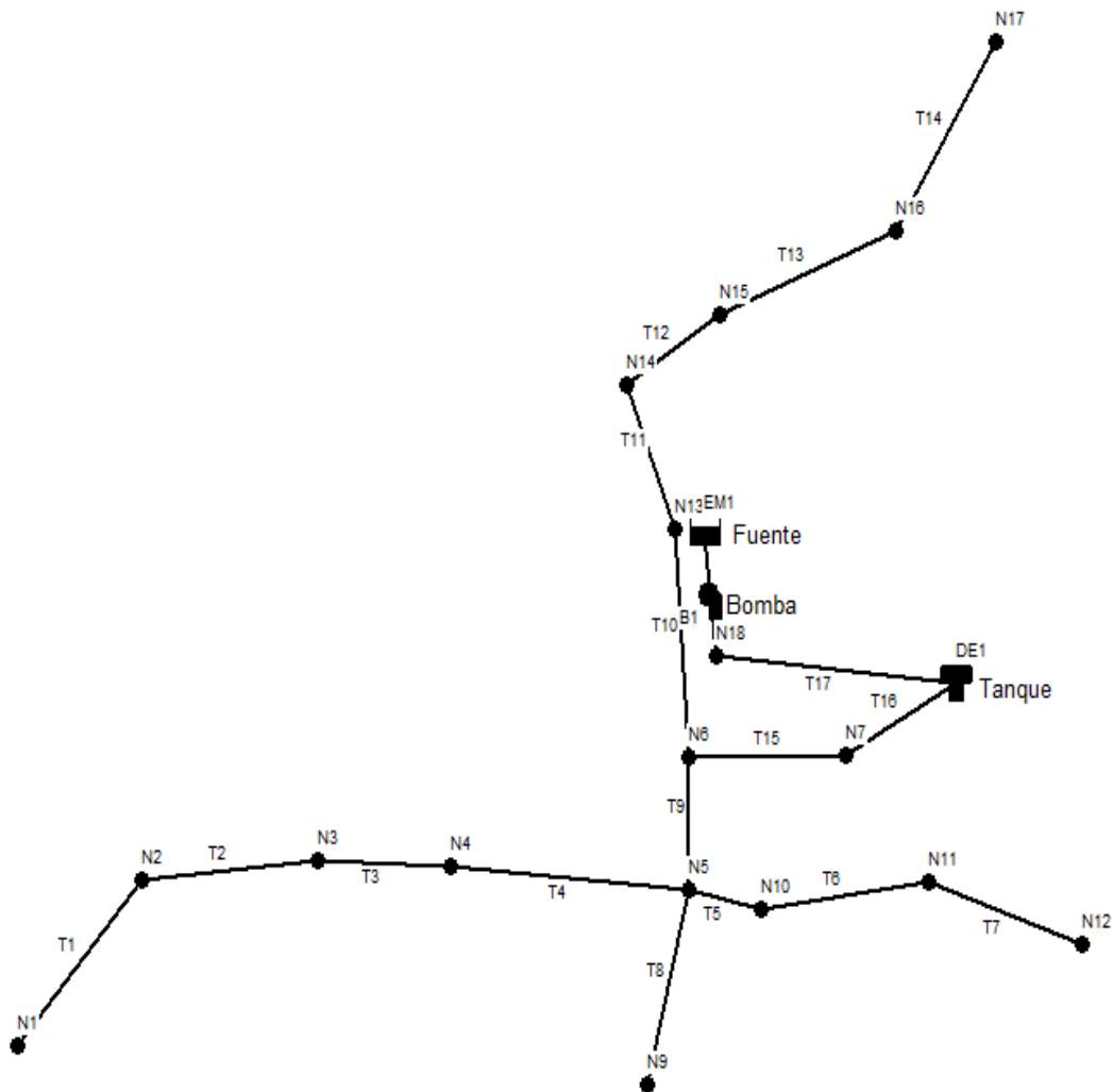
Figura 7: Línea de conducción y red de distribución
