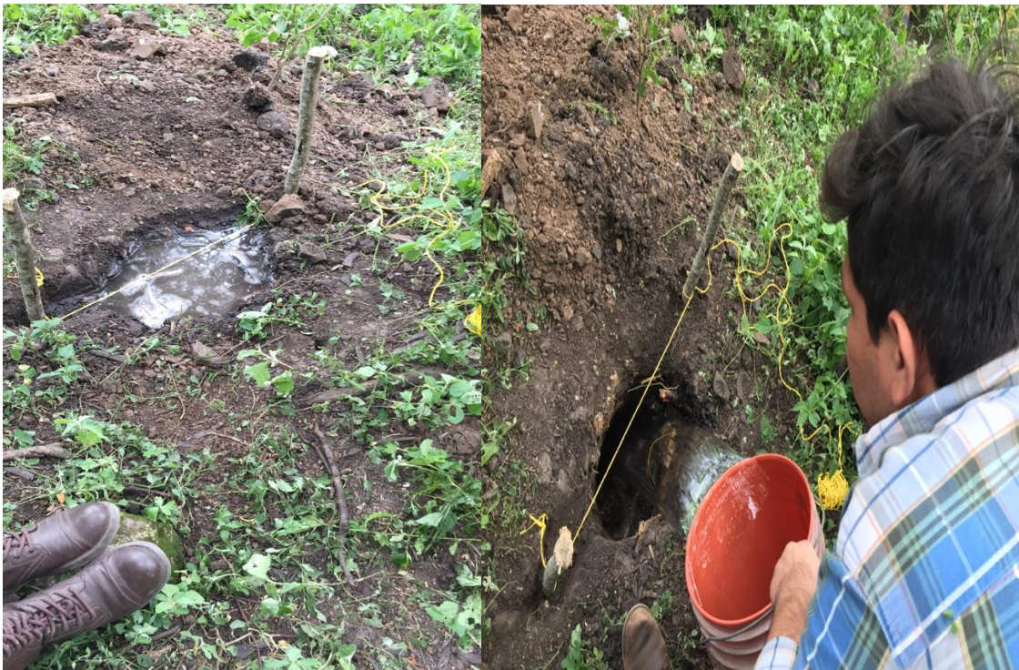
Prueba de infiltración
