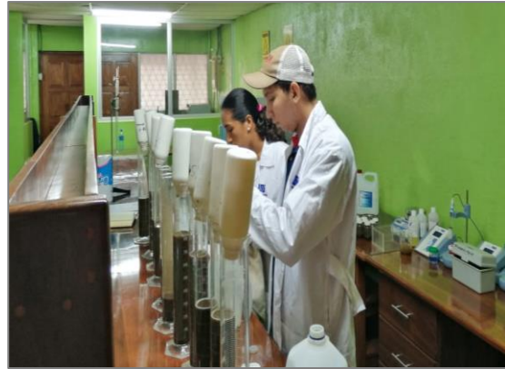
Fig. 15. Determinación de textura de suelos
