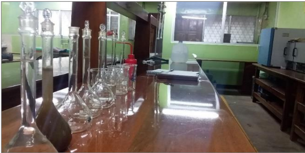
Fig. 17. Picnómetro (Lab. Edafología)
