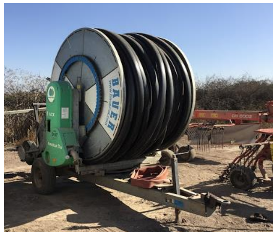
Fig. 3. Riego por carrete tipo enrollador
