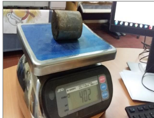
Fig. 16. Medida de peso de cilindros
