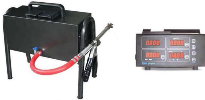
Ilustración 2 Equipo medidor de opacidad. Fuente: <http://gascheck.com.ar/opacimetro.htm>
