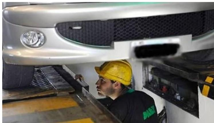
*Ilustración 8 Fosa de inspección de vehículos. Fuente: <http://noticias.desanrafael.com/inspeccion-tecnica-vehicular-que-debo-tener-en-cuenta-dd28.html>*
