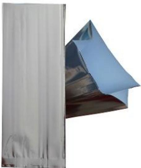
Una bolsa laminada es aquella conformada por 2 o más capas (tereftalato de polietileno, una capa metalizada y una última capa de polietileno), unidas entre sí por medio de adhesivos. La función de las bolsas laminadas es ofrecer mayor seguridad, hacer barrera al oxígeno y a la humedad para proteger tu producto.(L. Sánchez, 2017).
