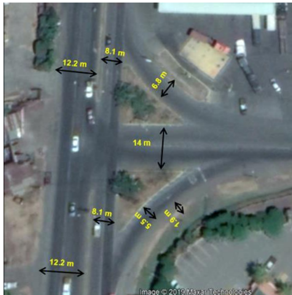
Ilustración 10. Derecho de Vía el Empalme PETRONIC (20+780)
