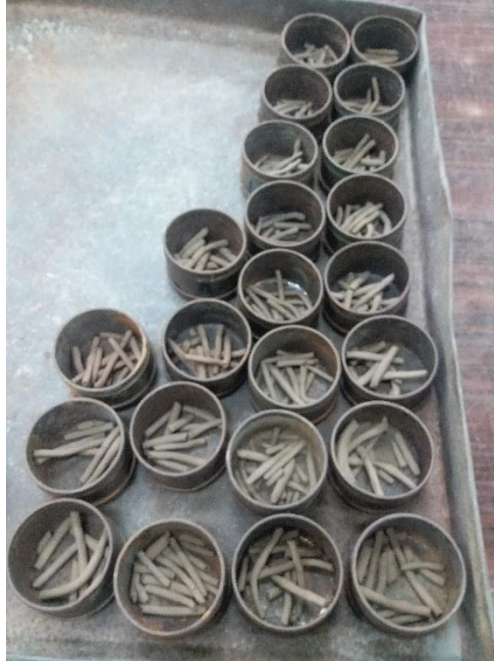
Fotografía 2. Proceso del ensayo para determinación de límite plástico
