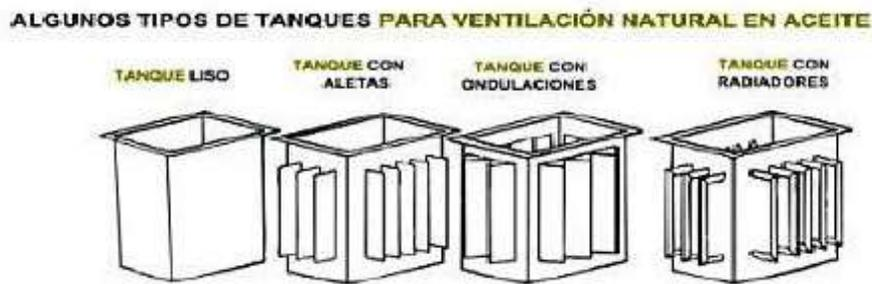
Ilustración 5. Algunas formas constructivas de tanques
