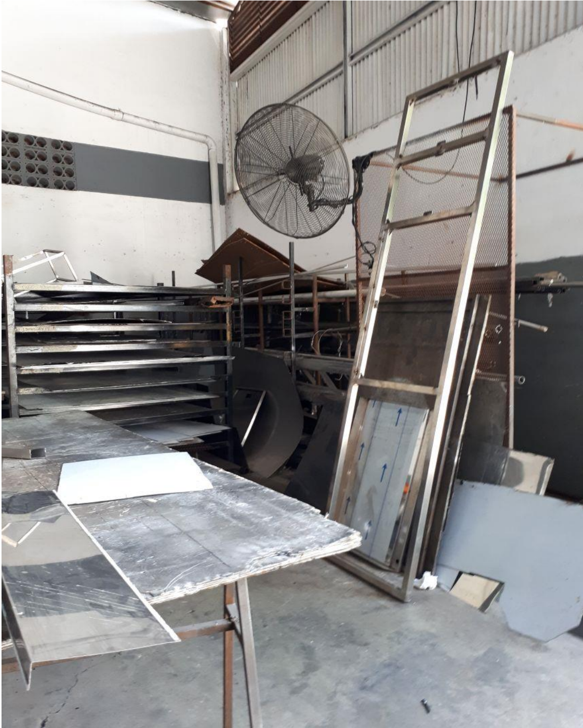
ANEXO 1: Obstaculización de pasillos por material no almacenado
