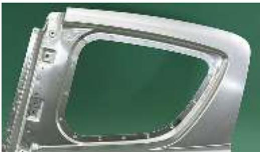
Gambar 2. FSSW pada rear door Mazda RX- 8 2003 [1].
