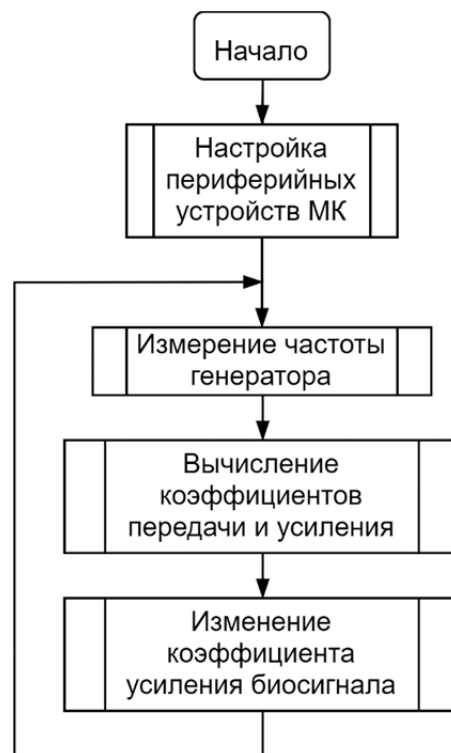
Рис. 1. Алгоритм программы системы компенсации нарушения кожно-электродного контакта
