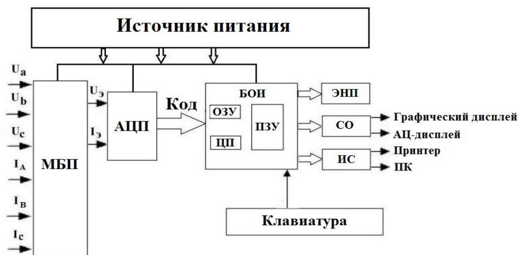
Рис. 1. Структура многофункционального преобразователя величин и параметров электрической энергии во вторичный сигнал:
