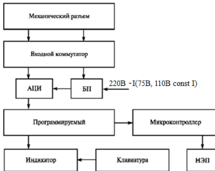
Рисунок 1. Структурная схема диагностики электрических цепей управления электроподвижного состава при помощи стенда на базе ЭВМ: НЭП-накопитель на электронных платах; АЦИ-алфавитно-цифровой индикатор отображения информации; БП-блок питания.
