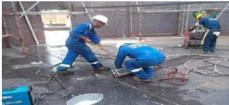
figura 6. Procedimiento cámara de vacío en tanque cilíndrico vertical. (Cárdenas, 2014)
