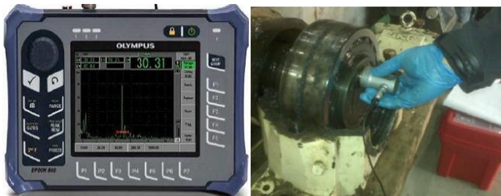
figura 8. Epoch 600 y escaneo con palpadores en eje. (cardenas, 2014)
