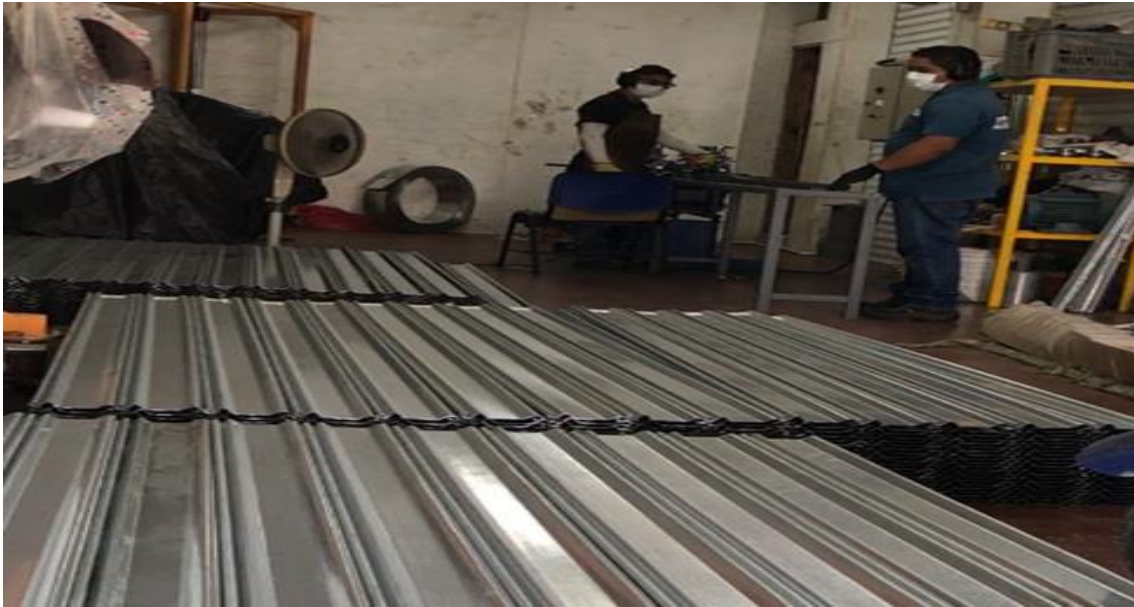
Figura 4-5. Flejes estructurales durante la fabricación.
