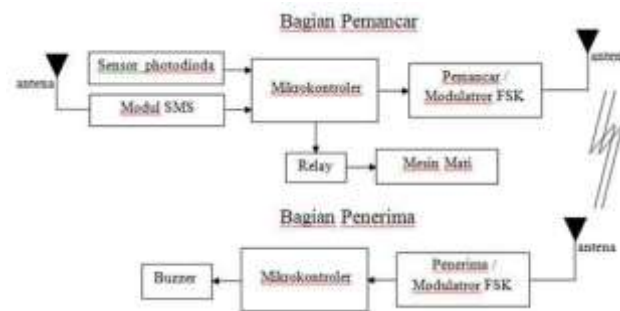
Gambar 7. Diagram Blok Sistem Keseluruhan Keamanan Mobil di Area Sekitar Rumah
