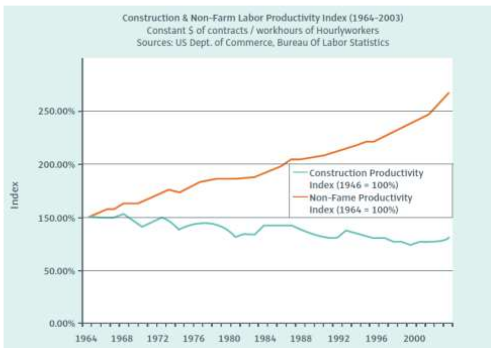
Figura 9. Productividad de la construcción comparada con otras industrias en Estados Unidos (Fuente: McGHC - SmartMarket Report 2009 - The Business Value of BIM).
