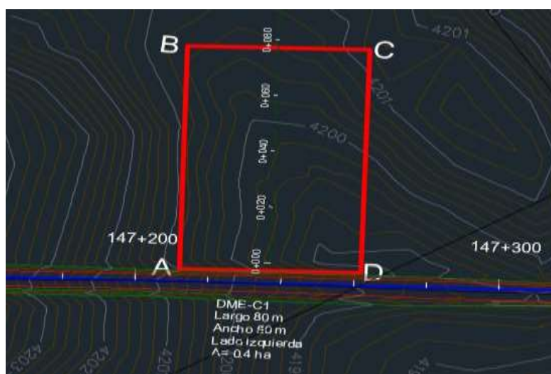
Figura 27. Plano de Ubicación de DME – 01. (Fuente: Proyecto Integración Vial Tacna – La Paz, Tramo: Tacna – Collpa (Frontera con Bolivia), Sub Tramo 3: Km 146+180 – Km 187+404).
