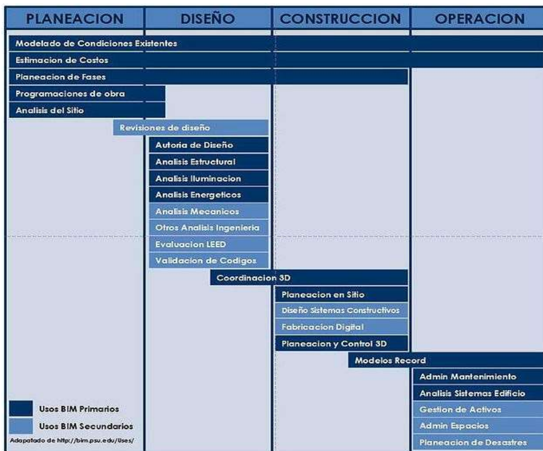
Figura 57. Usos BIM a lo largo de un ciclo de vida del edificio. (Fuente: The Computer Integrated Construction Research Program at The Pennsylvania State University (2011)).
