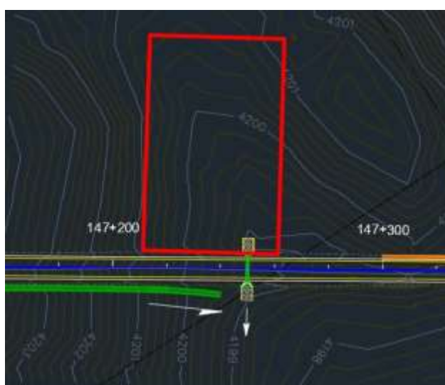
Figura 3. Incompatibilidad entre planos de diferentes especialidades. (Fuente: Proyecto Integración Vial Tacna – La Paz, Tramo: Tacna – Collpa (Frontera con Bolivia), Sub Tramo 3: Km 146+180 – Km 187+404).
