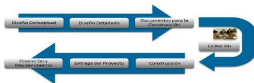
Figura 26. Proceso de desarrollo de proyectos de construcción basados en el sistema Diseño Licitación y Construcción. (Fuente: Alcántara (2013)).
