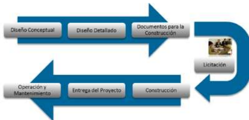
Figura 18. Proceso de desarrollo de proyectos de construcción basados en el sistema Diseño, Licitación y Construcción. (Fuente: Alcántara (2013)).
