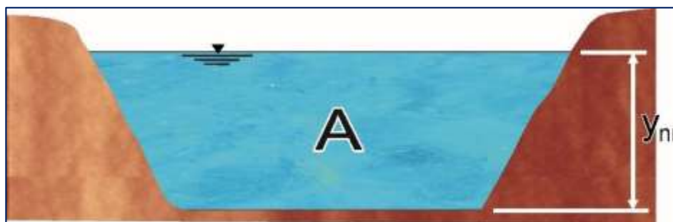
Figura 7: Tirante de la Quebrada. (Fuente: Agua Potable para Poblaciones Rurales).
