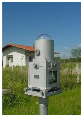
Figura 2.2.- Actinógrafo (Carrasco, M, Lenuur, L.(2009) Equipos aplicados al análisis y comportamiento de la radiación solar)
