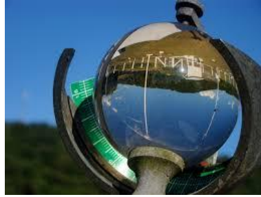
Figura 2.3.- Heliógrafo de Campbell-Stokes (Carrasco, M, Lenuur, L.(2009) Equipos aplicados al análisis y comportamiento de la radiación solar)
