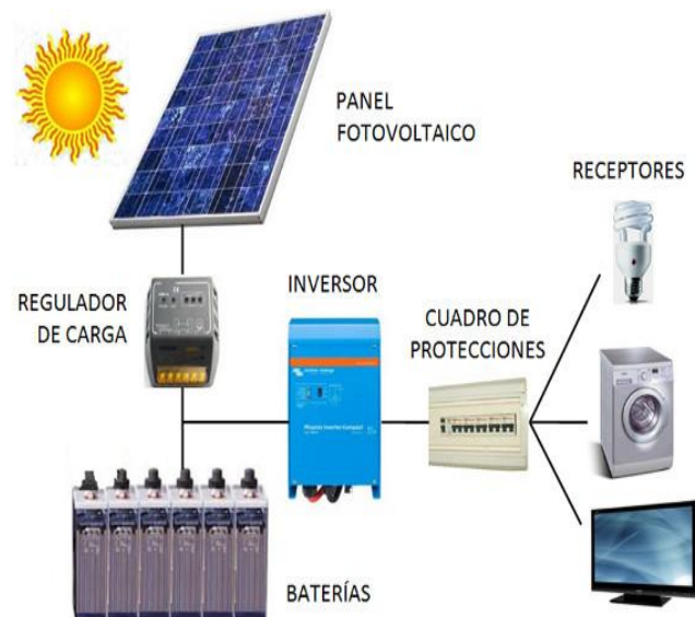
Figura 1.2- Sistema fotovoltaico aislado de la red (Carrasco, M, Lenuur, L.(2009) Equipos aplicados al análisis y comportamiento de la radiación solar)
