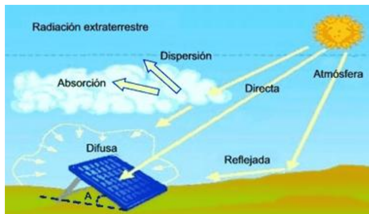
Figura 1.1.- Descomposición de la Radiación Solar (Basantes, E, Lechón, L.(2011) Analisis estructural del comportamiento sistemas solares y su radiación)
