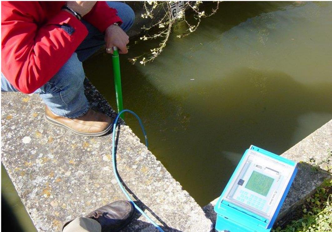
**Figura 3.5. Medición del flujo de agua con flujómetro ultrasónico.**
