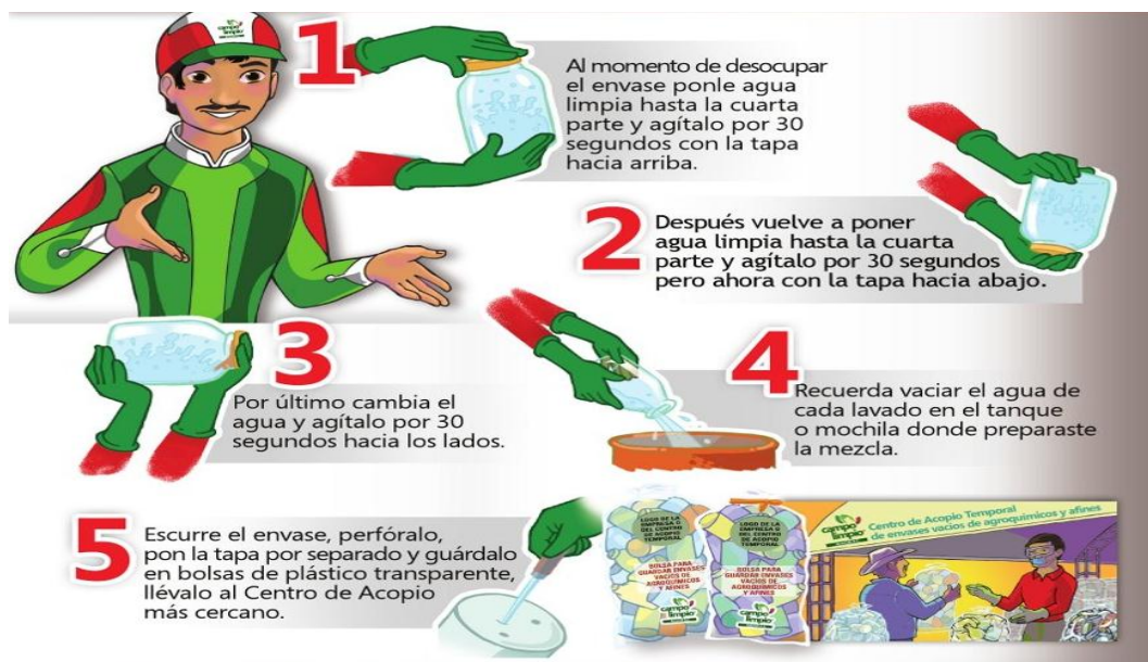
Figura 7. Ilustración de cómo realizar el triple lavado de los envases.
