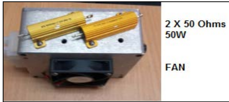
Figura 4.11 Resistencias para el circuito de enfriamiento
