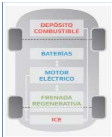
Figura 1.8 Estructura del vehículo híbrido eléctrico
