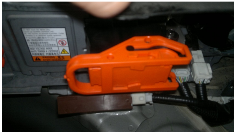
Figura 3.13 Desmontaje del Jumper de seguridad
