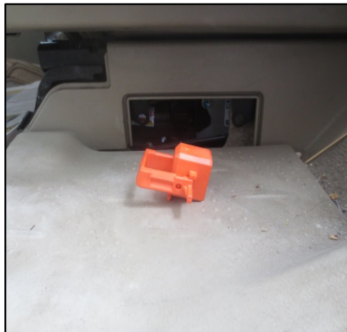
Figura 1.4 Jumper de seguridad Toyota
