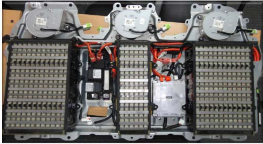
Figura 3.2 Bloques de la batería HV del Toyota Highlander
