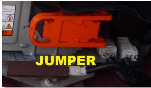
Figura 3.1 Jumper de seguridad
