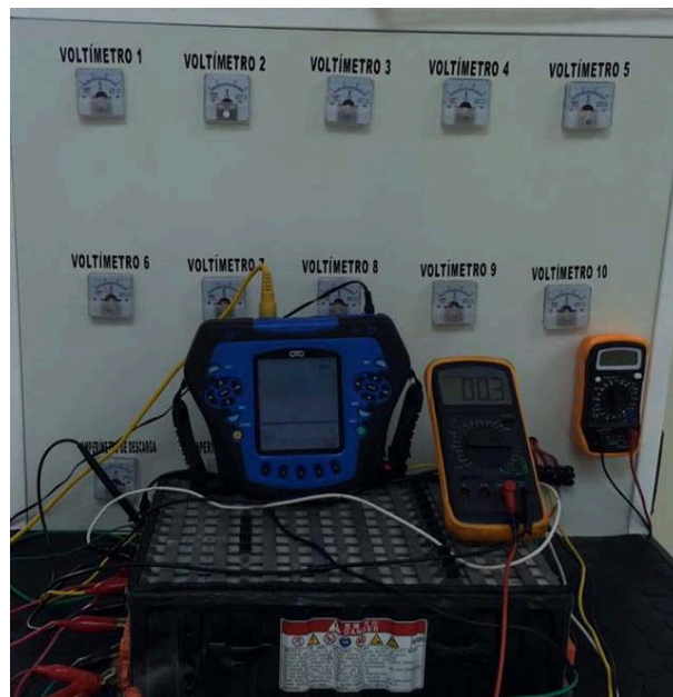
Figura 3.3 Batería de alta tensión en el banco de pruebas
