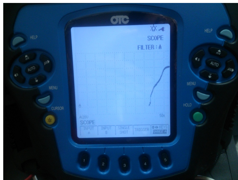
Figura 3.11 Curva de carga de la batería en el osciloscopio
