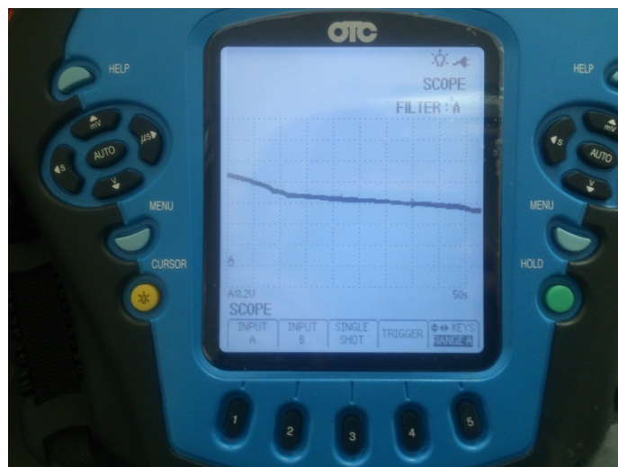
Figura 3.10 Curva de descarga de la batería HV bloque I
