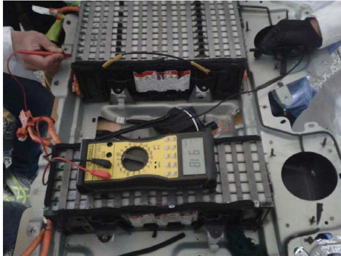
Figura 3.4 Medición de voltaje de cada celda
