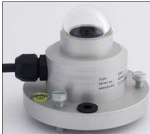
Figura 6. Piranómetro, medición de la radiación global, directa y difusa Fuente: (Schallenberg, 2008)
