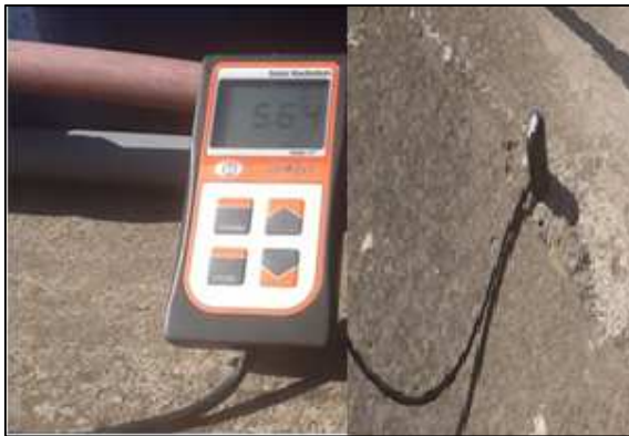
Figura 34. Equipo piranómetro haciendo las mediciones de los datos Fuente: Herrera L. (2018)
