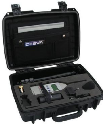
Gráfico 15. Sonómetro CESVA SC-260 TIPO II
