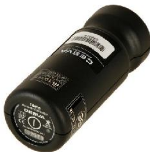
Gráfico 16. Calibrador sonoro CESVA CB004 TIPO II
