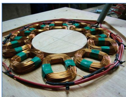
Figura 5. 21. Ensamblaje del bobinado del estator.
