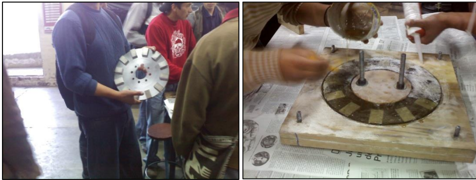
Figura 5. 22. Fotografías donde se muestra el ensamble y encastado de uno de los rotores realizados en la Universidad Técnica de Ambato.
