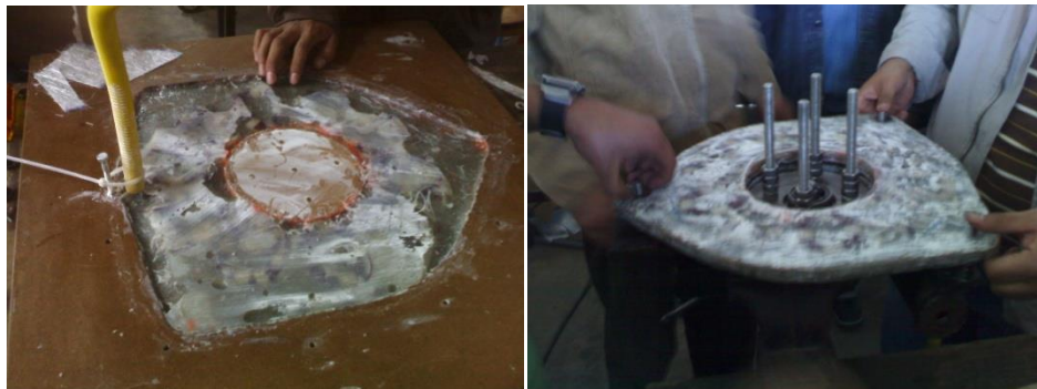
Figura 5. 23. Estator en el molde ya encapsulado.
