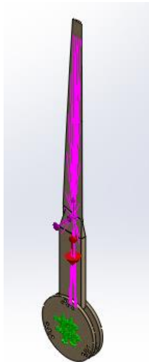
Figura 5. 15. Mallado del álabe para aplicación de cargas.
