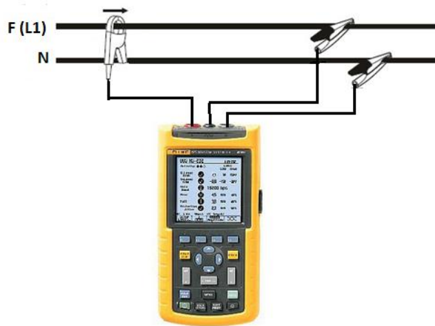
Figura 20: Conexión del analizador a un sistema de distribución trifásico
