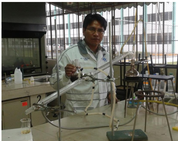
FIGURA 4.20 ENSAYOS CON DOS REFRIGERANTES LIEBIAC
