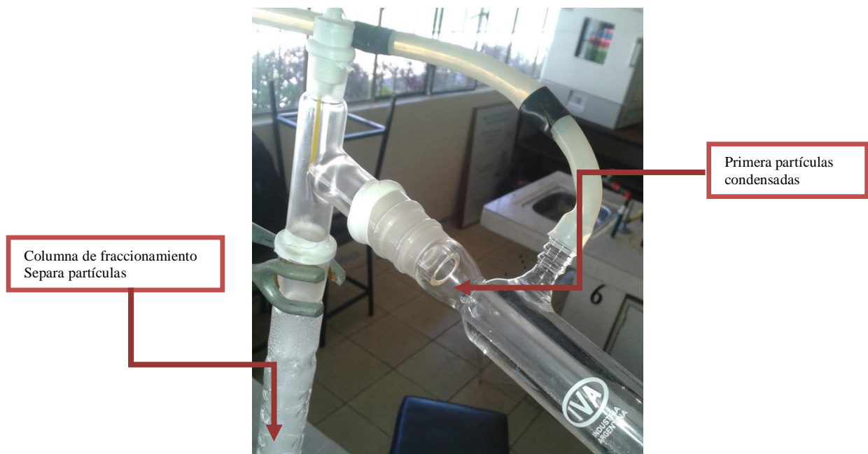
FIGURA 4.12 CONDENSADOS DE COMBUSTIBLE
