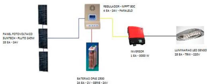
Figura 5.36.- Circuito de conexión del sistema
