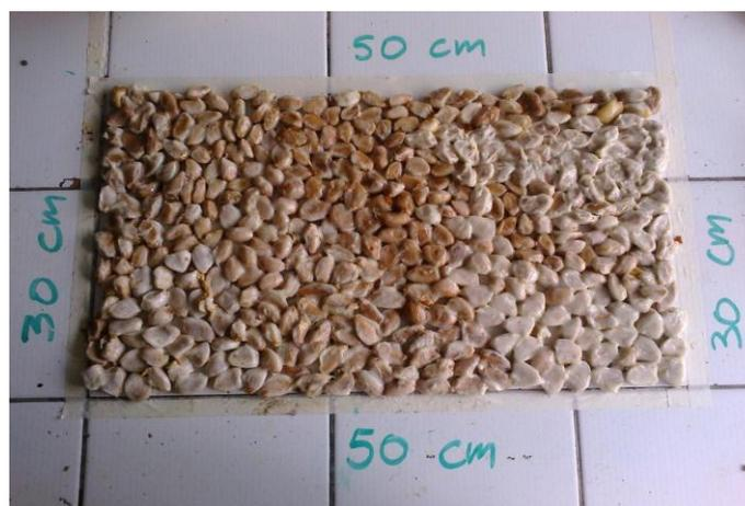
**Figura 4. 3.** Determinación de la superficie específica del cacao en grano para el secado
