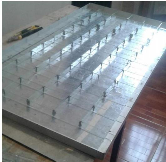
**Figura VII.2. Colector con cubierta Hexagonal**
