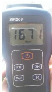
**Figura 4. 7.** Medidor de irradiación solar
