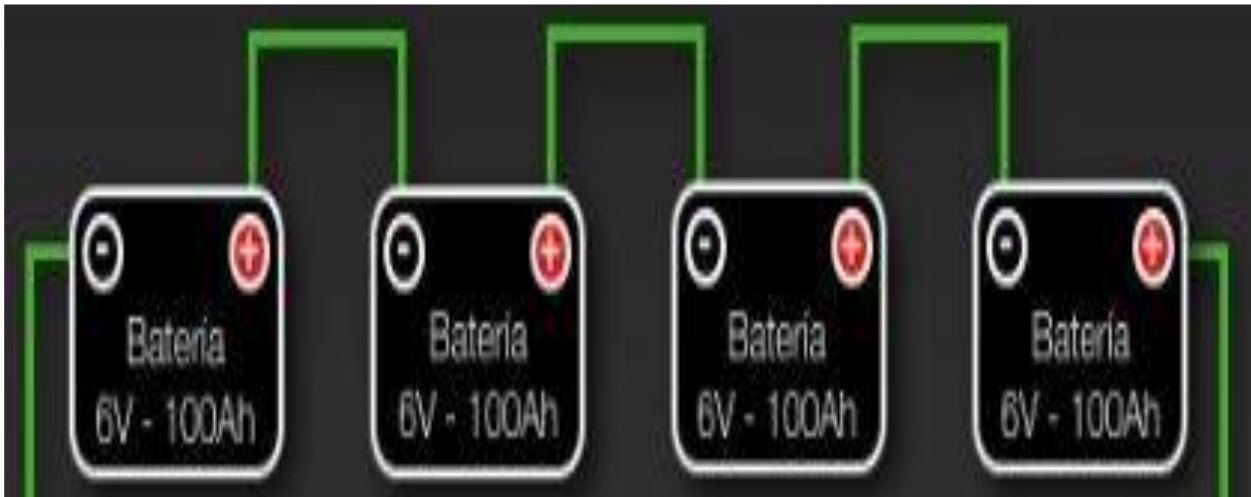
Figura 13 Conexión de baterías en serie
