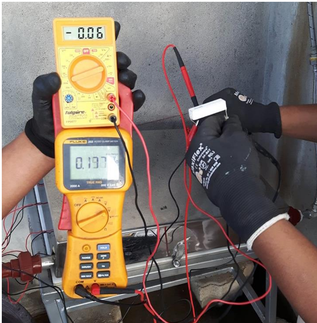
Medición de corriente con el metodo de corto circuito
