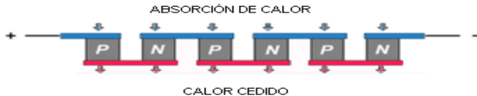
Figura 5 Disposición de los semiconductores en la célula Peltier
