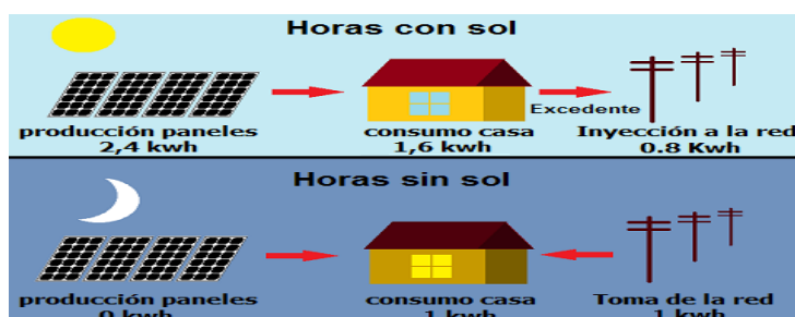
Figura 3.16. Instalación fotovoltaica conectada con balance neto. Fuente: [29].
