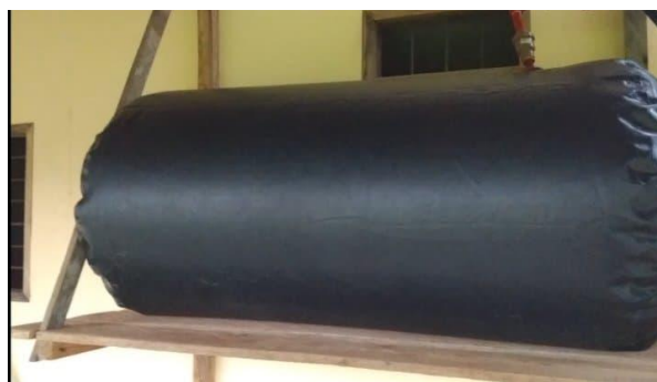
Figura 8. Gasómetro. Fuente: Autores
