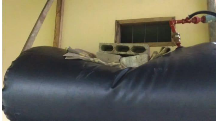
Figura 1. Bloques ejerciendo una fuerza al gasómetro
