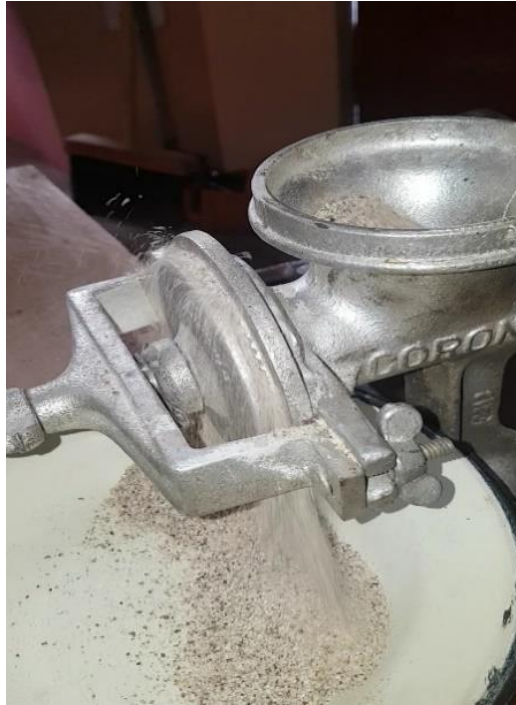
Figura 24. Molido de la pulpa deshidratada del rechazo de banano.
