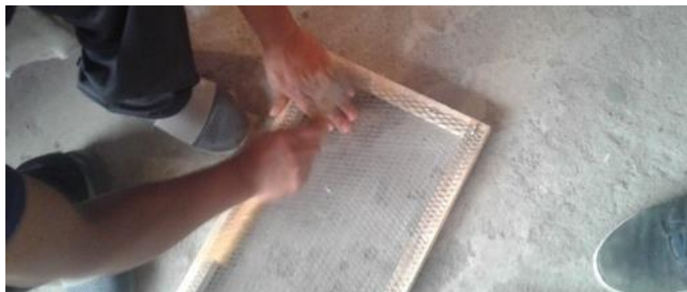
Figura 8. Grapado de mallas en la bandeja del horno artesanal.
