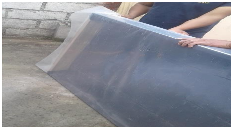
Figura 4. Forrado del colector (plástico blanco).
