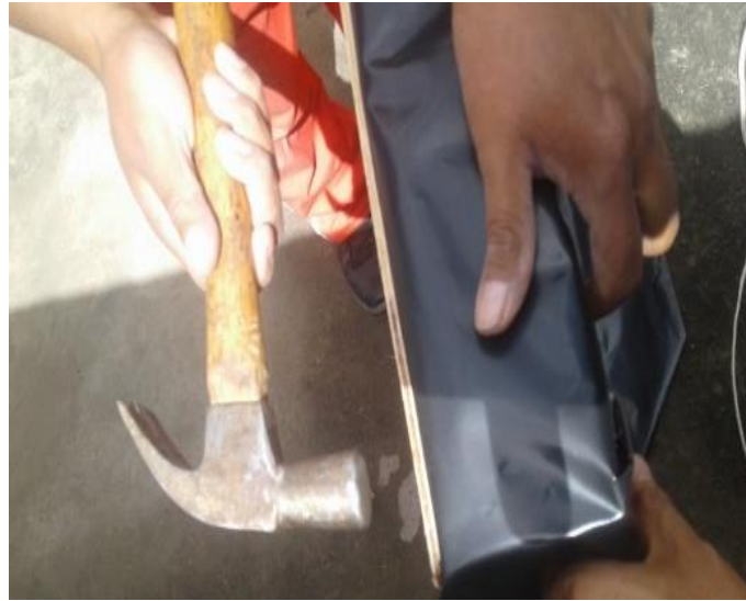
Figura 3. Forrado del colector (plástico negro).
