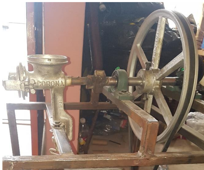
Figura 15. Colocación del molino.
