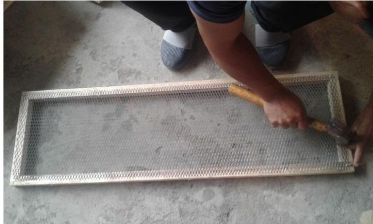
Figura 7. Unión de tiras para bandejas del horno artesanal.
