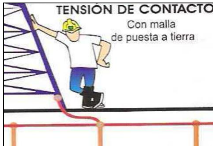
Figura 3.17: Tensión de contacto Fuente: [20]
