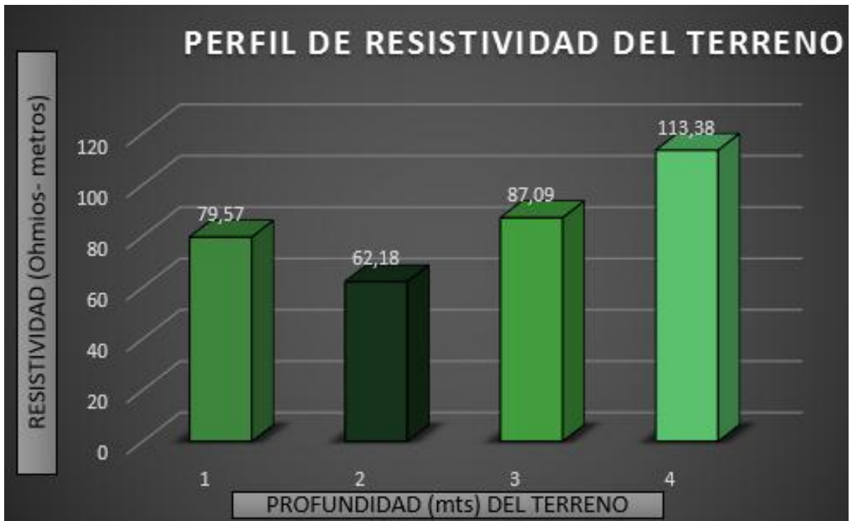
Anexo 13: Perfil de resistividad del terreno.
