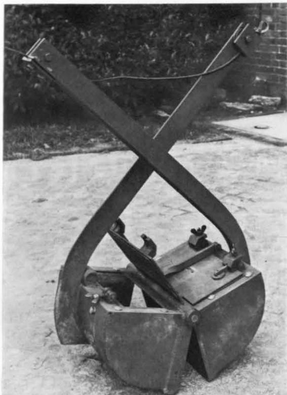
Abb. 24. Backengreifer (Nr. 28) groß, halb geöffnet, linke Deckelklappe geöffnet, rechte mit Ventilklappe sichtbar
