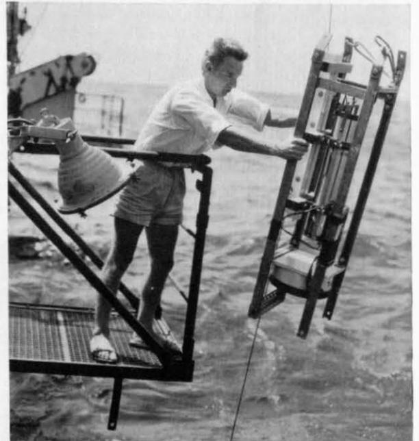
Abb. 30. Pinger (Nr. 35). Das Gerät wird über meereskundlichen Geräten am selben Draht angeklemt. Oben im Gehäuse: Pinger-Steuerung, unten Schallgeber Sonar Pinger
