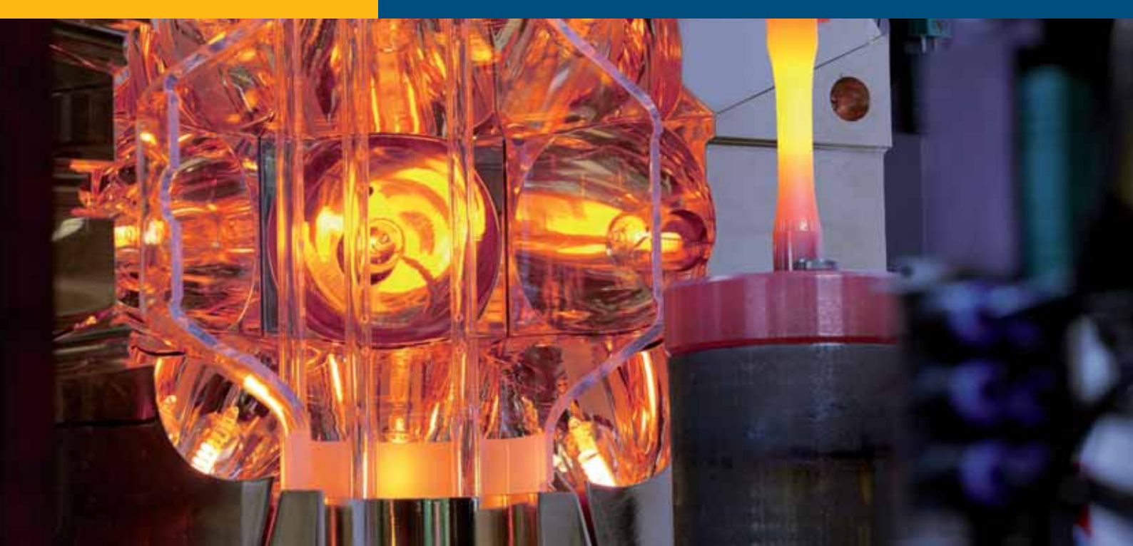
Halogenlampenofen im Labor des Instituts für Energie- und Klimaforschung: Die einzelnen Halogenlampen können einzeln angesteuert werden, wodurch rasche und extreme Temperaturschwankungen nachgestellt werden, die in der Praxis – also im Inneren von Kraftwerksturbinen – bedeutsam sind. Foto: Forschungszentrum Jülich
