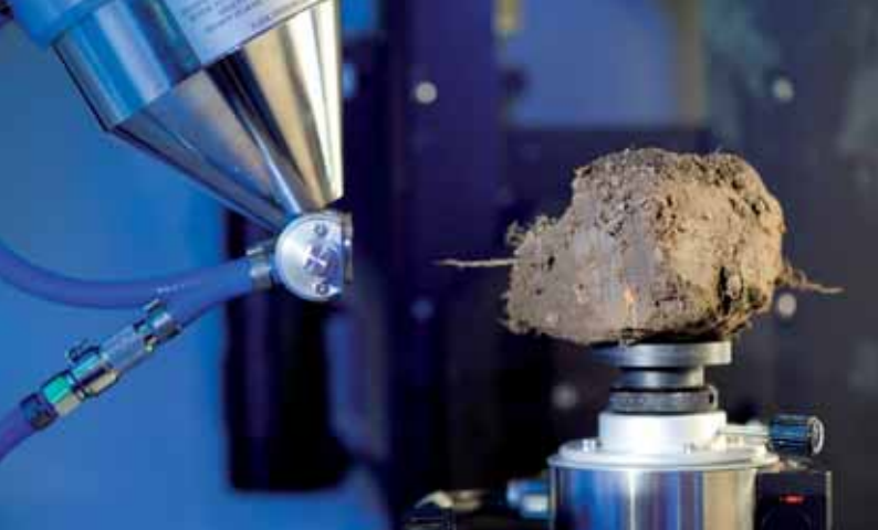
Hier trifft sich alles: Biosphäre, Atmosphäre, Hydrosphäre. Mit der Bodentomographie untersuchen Wissenschaftler eines der komplexesten Umweltkompartimente, um mehr über die Wasser-, Stoff- und Energieflüsse im Boden zu erfahren. Foto: UFZ/A. Künzelmann
