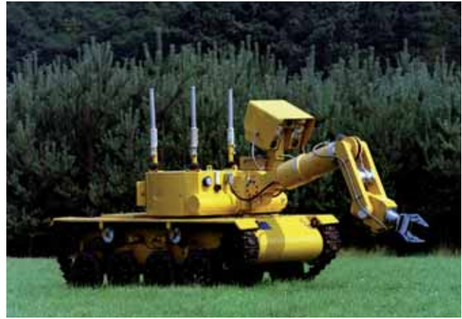
Fernsteuerbares Manipulatorfahrzeug des Kerntechnischen Hilfszugs (KTH), 1974. Foto: KIT-Archiv
