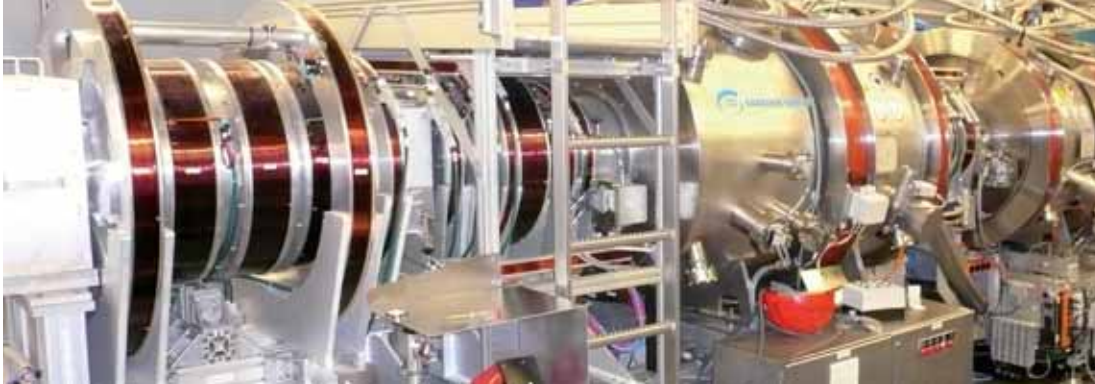
Neutronen-Spin-Echo-Spektrometer des Forschungszentrums Jülich am Oak Ridge National Laboratory. Foto: Oak Ridge National Laboratory
