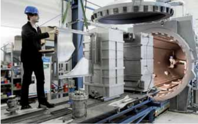
Im Drucktank der Versuchsanlage TOPFLOW werden Stoffströme und Strömungsmische aus Gasen und Flüssigkeiten unter praxisrelevanten Bedingungen untersucht. Foto: HZDR/O. Killig
