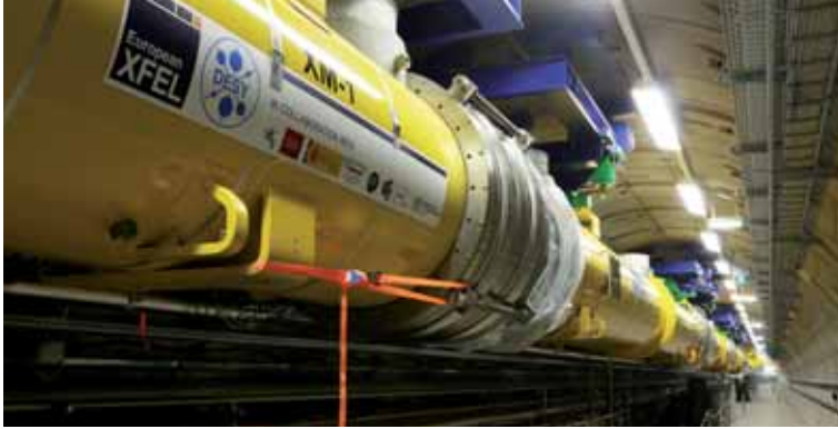
Röntgenlaser der Zukunft: Beschleuniger-Module im Tunnel des European XFELs in Hamburg. Foto: DESY/D. Nölle
