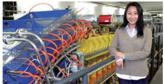
Kühlersynchrotron „COSY“ zur Beschleunigung von Protonen und Deuteronen am Institut für Kernphysik des Forschungszentrums Jülich. Foto: Forschungszentrum Jülich/R.-U. Limbach
