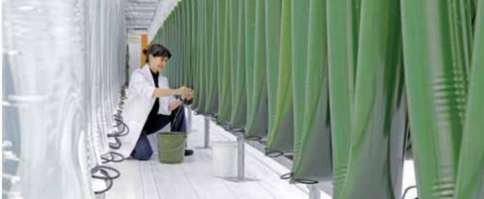
Am Algen Science Center untersuchen Jülicher Wissenschaftler die optimalen Bedingungen für die Produktion von Algen sowie für die Umwandlung von Algen in Biokerosin. Sie vergleichen dabei unterschiedliche Bioreaktorsysteme. Foto: Forschungszentrum Jülich
