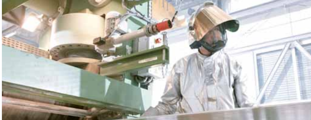
Innovatives Verfahren an der Gießwalze: Die Magnesium-Bleche sollen Fahrzeuge leichter machen. Foto: HZG/C. Schmid
