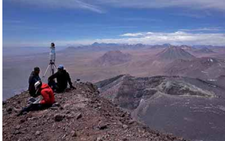
Ein Laser scannt den Gipfel des 5592 Meter hohen Lascar-Vulkans, eines der aktivsten Vulkane Chiles. Ziel der Laser-Messungen ist die Erfassung der Struktur der komplexen Krater und ihre Änderung. Foto: GFZ/T. Walter
