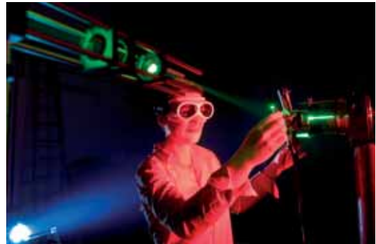
Mit Laserstrahlen und Hochgeschwindigkeitskameras der Entstehung von Fluglärm auf der Spur: Eine Forscherin vom DLR Göttingen justiert das Modell eines Hubschrauberrotors für die Messung. Foto: DLR
