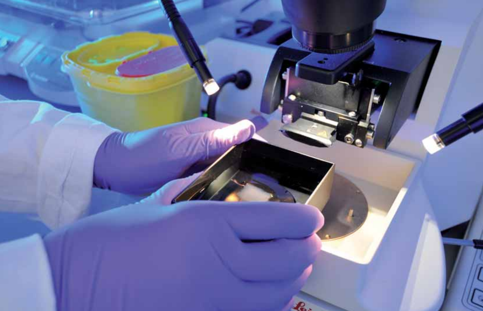
Gewebeschnitte für die Immunhistochemie: In einem Mikrotom werden 60 – 400 Mikrometer dünne Gewebeschnitte gemacht, die dann mit Antikörperfärbungen aufbereitet werden. Foto: DZNE/F. Bierstedt
