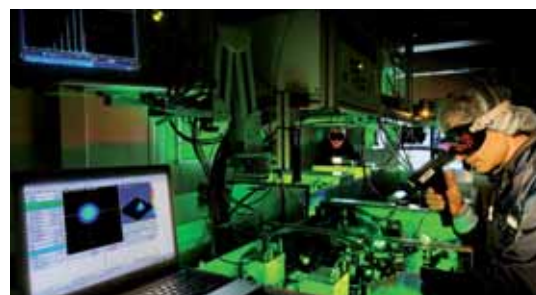
Am Ultrakurzpuls-Laser DRACO erforschen Wissenschaftler des Helmholtz-Zentrums Dresden-Rossendorf die Laser-Teilchenbeschleunigung mit dem Ziel, kompaktere Beschleuniger zu entwickeln. Foto: HZDR/J. Lösel
