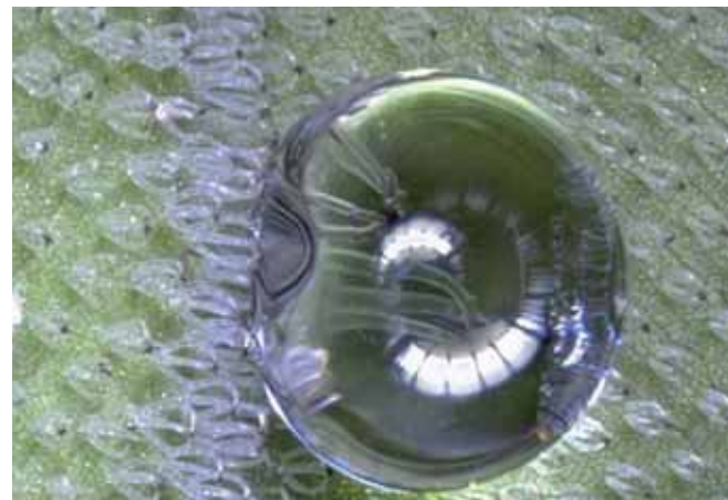
Erforschung und Nachbau des Salvinia-Effekts: Die technologische Nutzung von Luftkissen zwischen Blatt und Wasser kann die Schifffahrt künftig energieeffizienter machen. Foto: KIT/Forest&Kim Starr@wikimedia.org/T. Schimmel
