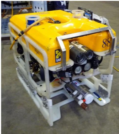
Abb. 4: Im Tiger ROV eingebautes HISEM-System.
