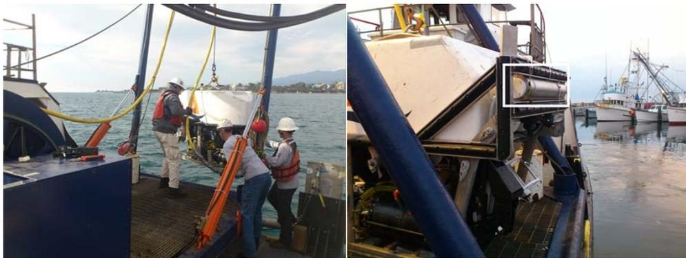
Abb. 10: (a) Einsatz des "HYSUB 20" ROVs von Steuerbord der M/V Danny C; (b) Die HISEM Sensoreinheit (innerhalb der weißen Umrandung) konnte stoßsicher hinter dem vorderen ROV-Fänger montiert werden.
