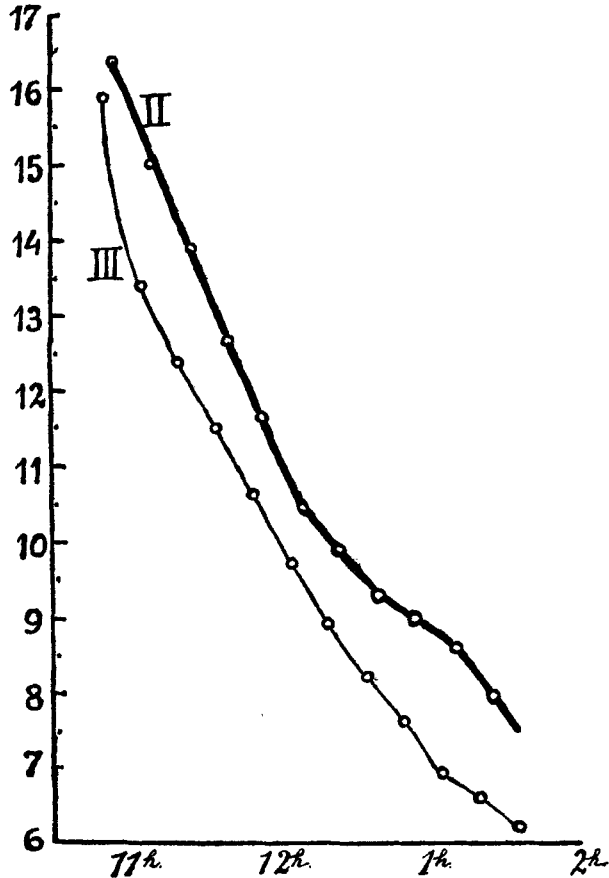
Fig. 12. Kurve II zeigt die Abkühlung des Salzwassers, wenn eine Schale mit Eis auf seiner Oberfläche angebracht wird, Kurve III die Abkühlung, wenn diese Schale mit einer Kältemischung gefüllt wurde.
