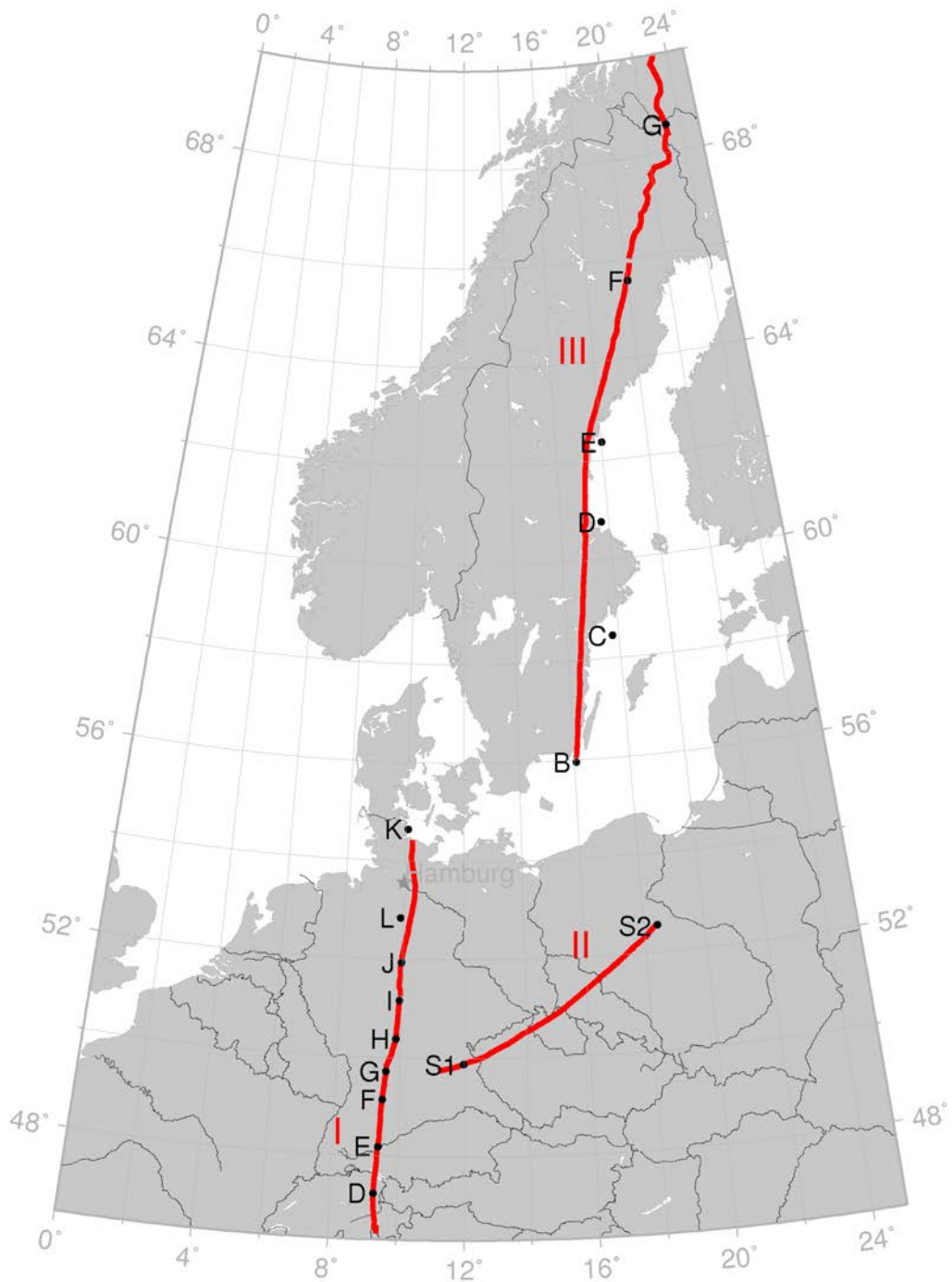
Abbildung 5.65: Übersicht über drei europäische Refraktions-Langprofile (I=EGT, II=SUDETES, und III=FENNOLORA). Schußpunkte (Sprengungen) sind durch Buchstaben markiert. Tektonische Einheiten an der Oberfläche sind schematisch eingezeichnet. Transversale Mercatorprojektion mit einem zentralen Meridian bei 10°.
