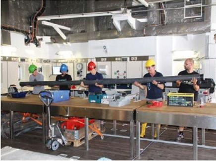
**Schwerelot.** Im Hangar wird alle 20 bis 25 cm Porenwasser aus dem Sediment entnommen.
